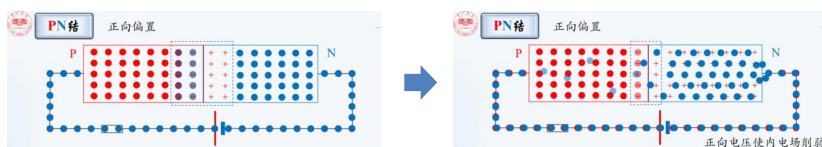
图4 PN结正向偏置示意图
