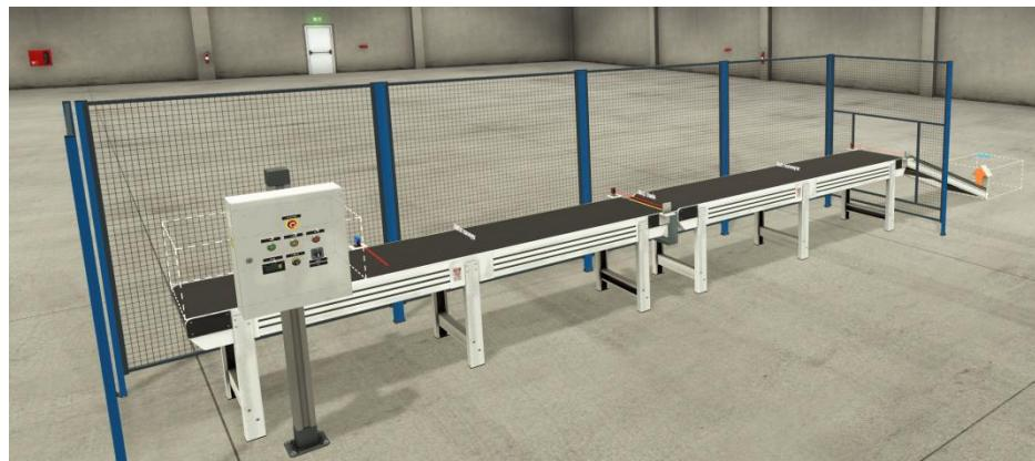
**教师演示（5分钟）：**展示 Factory I/O 场景，并演示“按下虚拟按钮，虚拟传送带转动”的完整流程，重点讲解 I/O 映射表的配置。（[书写板书，上机进行操作演示，并分解讲解](#)）
