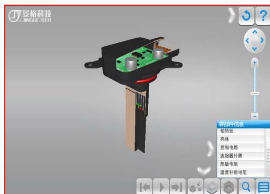
图 4 热线式空气流量计结构
